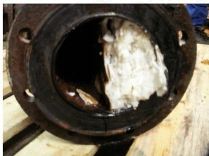
Querschnitte von Wasserleitungen, in denen das Wasser stagnierte (Foto Bublitz)
